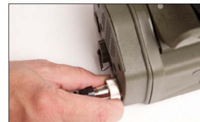
Ajuste con la mano el anillo del conector.
